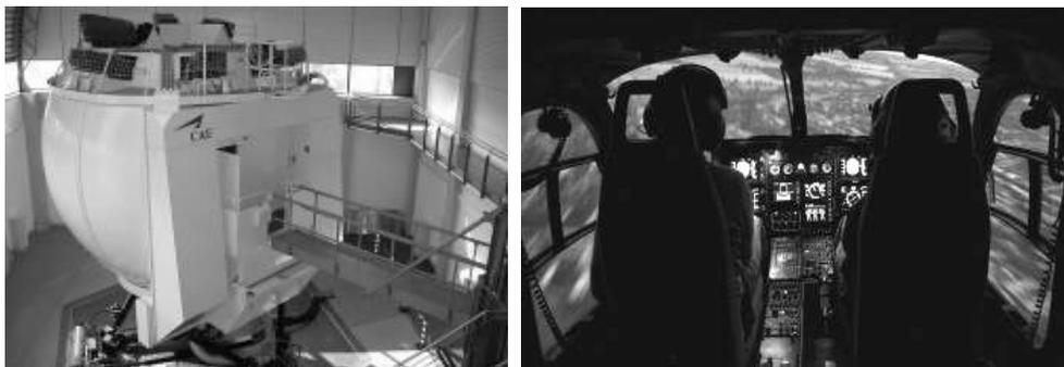
Abbildung 1: Simulator und Cockpit Mock-Up des Eurocopter (EC) 135 (eigene Fotografien).
