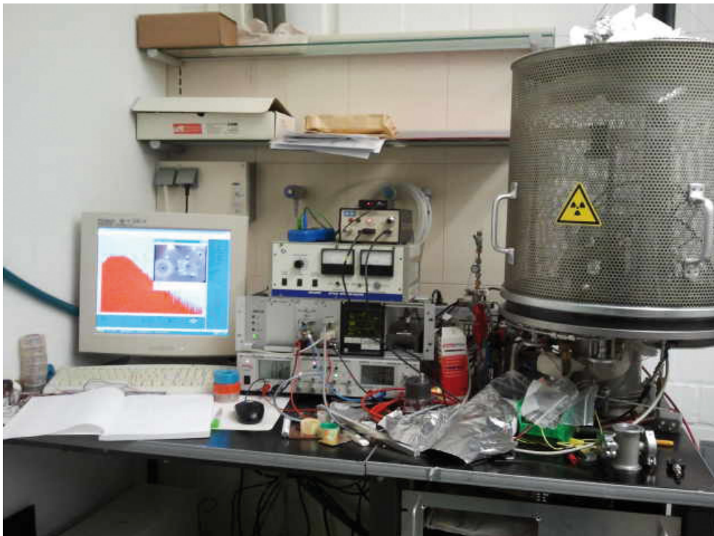
Abbildung 3-1: Foto des gesamten Versuchsaufbaus. Der Steuerrechner (links), die Elektronik-Einschübe (mittig) und die Vakuumkammer (rechts) sind zu sehen.
