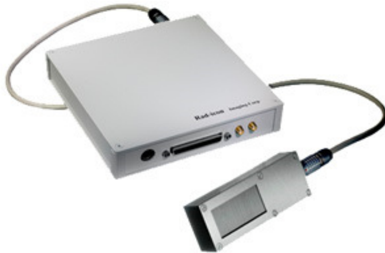
Abbildung 3-7: Rad-Icon Remote RadEye HR 2D-Detektor mit zugehöriger Ausleseelektronik. Die aktive Detektorfläche beträgt 27\text{ mm} \times 36\text{ mm} mit einer Auflösung von 1200 \times 1600 Pixel [Rad13].
