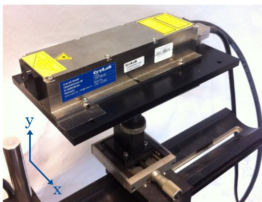
Abbildung 3.33: Auf optischer Schiene montierter DPSS-Laser mit Mikrometerschraube zur Positionierung in  $x$ -Richtung und stufenloser Positionierung in  $y$ -Richtung
