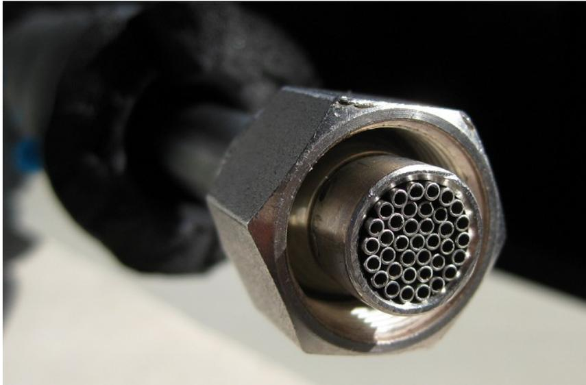
**Abbildung 4.6:** Beheizbares Edelstahlrohr mit 37 Edelstahlkapillaren. Das Edelstahlrohr wird als Zwischenstück in die Einlassleitung verschraubt.
