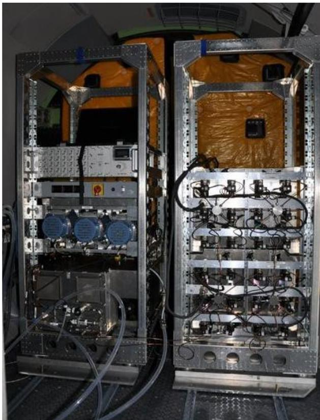
**Abbildung 3.1:** Einbau von MIRAH in den HALO-Gepäckraum (Foto: Marc Krebsbach).
