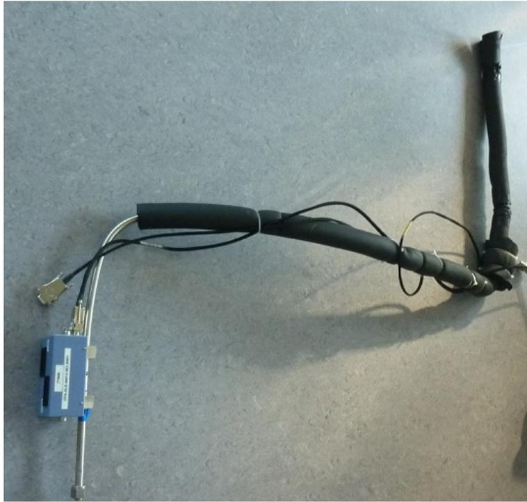
**Abbildung 4.1:** Beheizbares Edelstahlrohr (2m) mit Isolierung und Elektronikeinheit. Eingesetzt wurde das abgebildete Edelstahlrohr bei der HALO-Testmission TECHNO.
