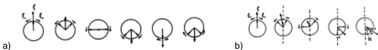
Abbildung 4-16: 236 Summenvektor aus der Überlagerung eines rechts und links circularpolarisierten Lichtstrahls: a) in Phase bei gleicher Wellenlänge; b) bei unterschiedlicher Wellenlänge (Fortpflanzungsgeschwindigkeit) mit \lambda_r > \lambda_l .
