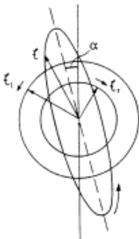
Abbildung 4-19: 236 Elliptische polarisierter Lichtstrahl nach Austritt aus einer circulardichrotischen Substanz. \zeta_l und \zeta_r sind verschieden. Der Summenvektor beschreibt eine schmale Ellipse. 236
