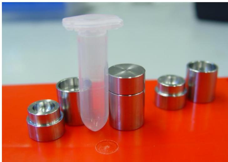
**Abbildung 20:** Fotografie der Edelstahlgefäße mit einem Volumen von 0,4 mL neben einem kommerziell erhältlichen 2-mL-Mikroreaktionsgefäß
