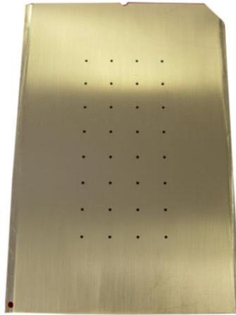
**Abbildung 18:** Fotografie eines Targets mit einem Design bestehend aus 4 x 8 Bohrungen
