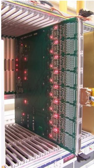
**Abbildung 2.20.:** Einzelnes CRC in einem VME-Crate. Zu erkennen sind die acht Anschlüsse, über welche die Verbindung zu den HBABs hergestellt wird.
