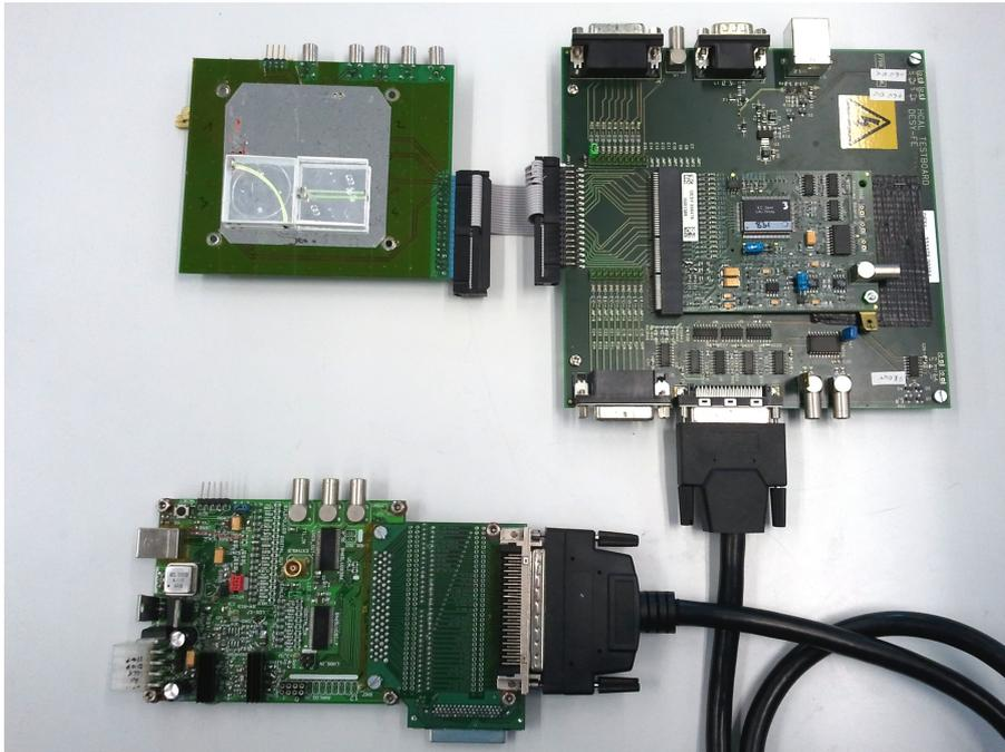
**Abbildung 3.3.:**  $\mu$ DAQ mit angeschlossenem Test-HBAB für ein HAB sowie einer Platine mit zwei Szintillatorkacheln.
