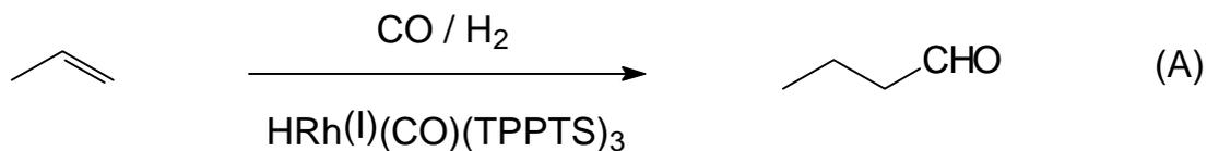
Sulfonierte Derivate des Triphenylphosphans, z.B. das  $\text{Ph}_2\text{P}(m\text{-C}_6\text{H}_4\text{SO}_3\text{Na})$  (TPPMS) **L2**<sup>[5]</sup>, werden in Form ihrer  $\text{Rh}^{\text{I}}$ -Komplexe bevorzugt als Katalysatoren sowohl für Hydroformylierungs-<sup>[2, 3, 6]</sup> als auch für Hydrierungsreaktionen<sup>[7-9]</sup> in Zweiphasensystemen eingesetzt.
