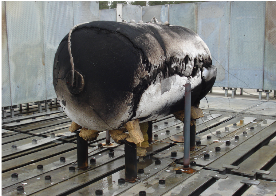
Abbildung A.6: Prüfling im Brandprüfstand nach dem Versuch
