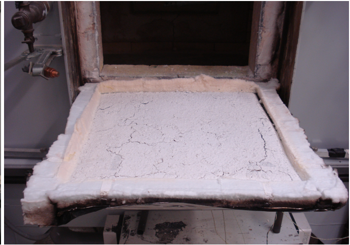
Abbildung 7.10: Platte nach der Brandprüfung
