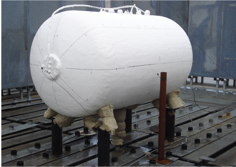
Abbildung A.1: Prüfling im Brandprüfstand vor Versuchsbeginn
