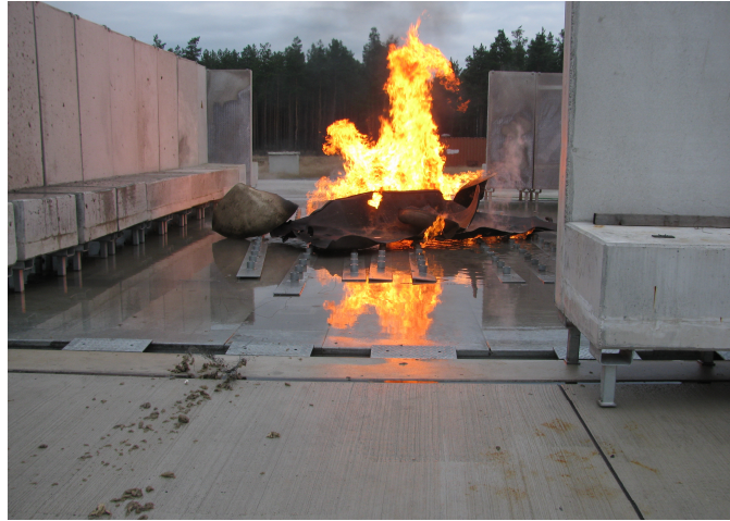
Abbildung 5.2: Versuchstank im Brandprüfstand unmittelbar nach dem Bersten aus [42]
