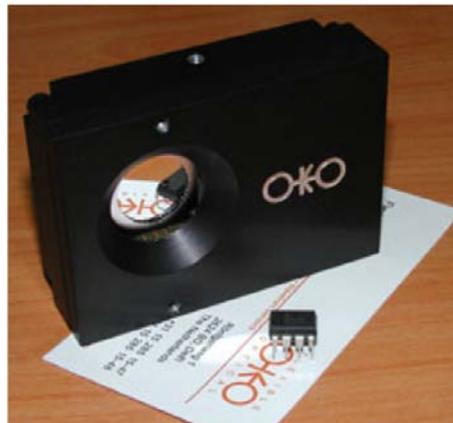
**Abbildung 2.9:** OKO Tech Membran-Spiegel MMDM 15 mm 37 Kanäle, aus [20]
