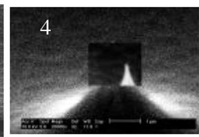
Abb. 5-16 : HSEM-Photos von 7,5 nm W-beschichteter Probe Si-n-W. Angabe des Durchmessers des verbliebenen Halses in nm.
