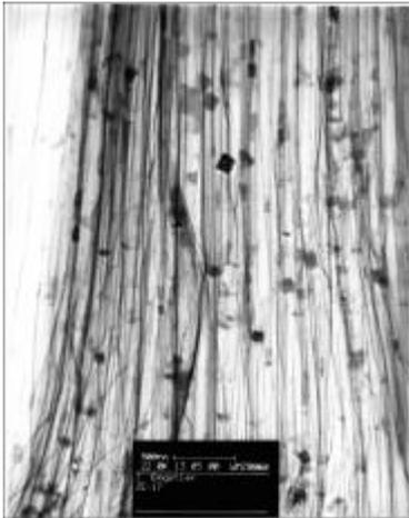
Abb. 7-12 : TEM Photo von mit Pyrolyse von Ferrocen generierten CNTs auf Probe CNT17c.
