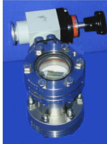
b : Zusammengesetzter Demonstrator mit Sichtfenster und Ventil (hinten).
