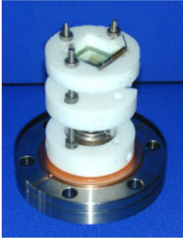
a : Innenaufbau auf CF40-Flansch mit Teflonhaltern und quadratischem Leuchtschirm (oben).
