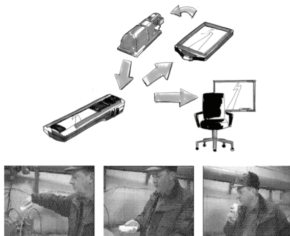
Abb. 25 Das Pucketizer Konzept (oben). Ein Inspektor der Wasseraufbereitungsanlage zeigt anhand eines Styropor-Modells des Pucketizers , wie er durch einfaches Hindeuten auf eine Komponente der Anlage ein „real world bookmark“ anlegen und eine mündliche Post-it-Notiz in das Gerät eingeben würde (unten). Tomas Sokoler/Jörn Nilsson/Thomas Binder/Nina Wetcke, 1998-1999.
