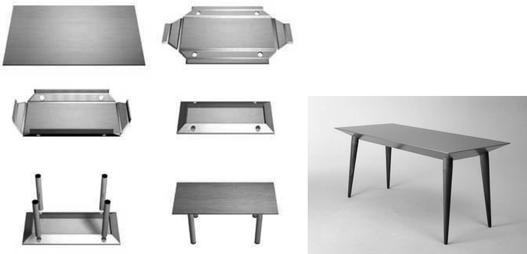
Abb. 50 a-b Tisch König Ludwig : Fertigungsablauf nach dem Folding-Verfahren. Entwurf: Jochen Gros
