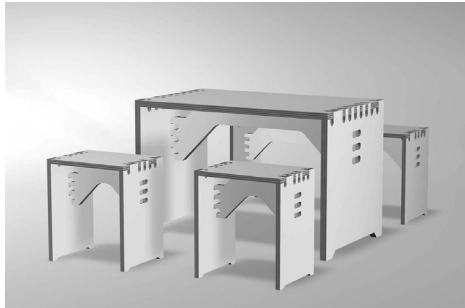
Abb. 48 a-c Digitale Holzverbindungen , basierend auf traditionellen japanischen und europäischen Vorlagen. Konzeption und Entwicklung: Jochen Gros, Friedrich Sulzer, C-Labor, 1998.
