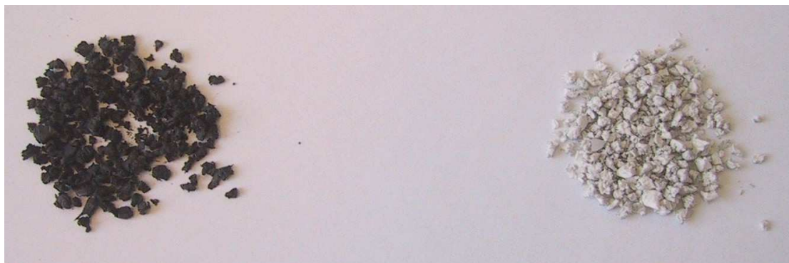
Abbildung 28: Zwei elastische Materialien nach Versprödung und Zerkleinerung mittels Schneidmühle SM 300
