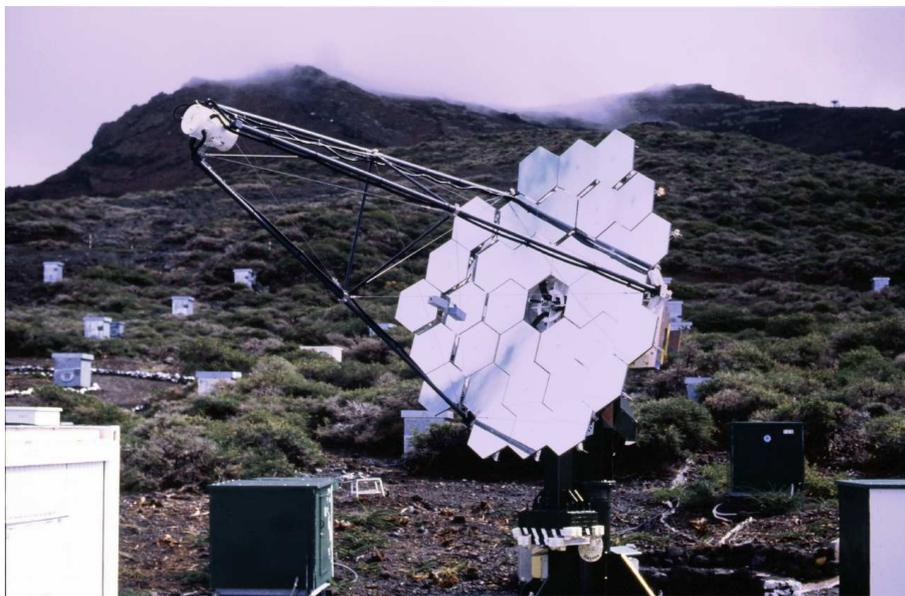
Abbildung 2.2: Das 10m<sup>2</sup>-Cherenkov-Teleskope CT1.
