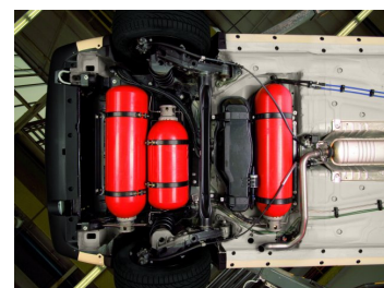
Abbildung 6.1.: Anbringung der Druckbehälter bei Opel Zafira, VW Caddy und Opel Combo [erd12a]
