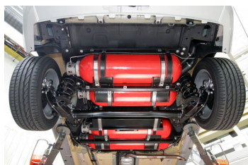
Abbildung 6.1.: Anbringung der Druckbehälter bei Opel Zafira, VW Caddy und Opel Combo [erd12a]
