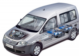
Abbildung 6.1.: Anbringung der Druckbehälter bei Opel Zafira, VW Caddy und Opel Combo [erd12a]
