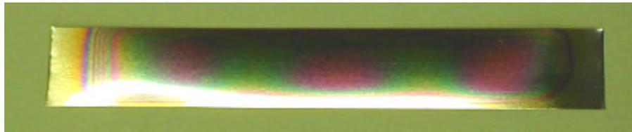
Abbildung 44: Fotografie einer gesputterten Mehrfachpufferschicht auf einem Plansee-Substrat
