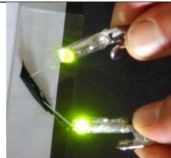
Abb. 94: Demonstration der Leitfähigkeit der Polypyrrolfolie
