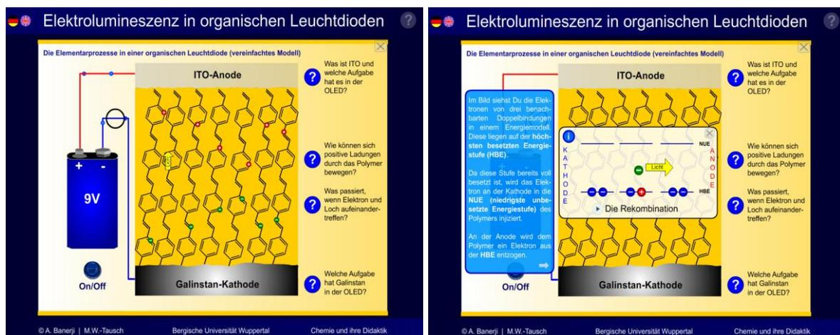
Abb. 87: Elementarprozesse der OLED im einfachen Modell (l). Genauere Betrachtung der Rekombination (r).
