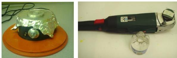
Abb. 62: Labor-Spincoater (l), low-cost Spincoater (r)
