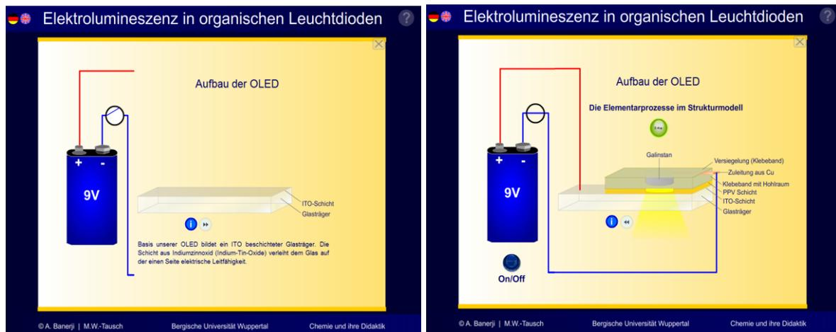
Abb. 86: Aufbau der Eigenbau-OLED vom ersten Schritt (l) bis zur fertigen OLED (r).
