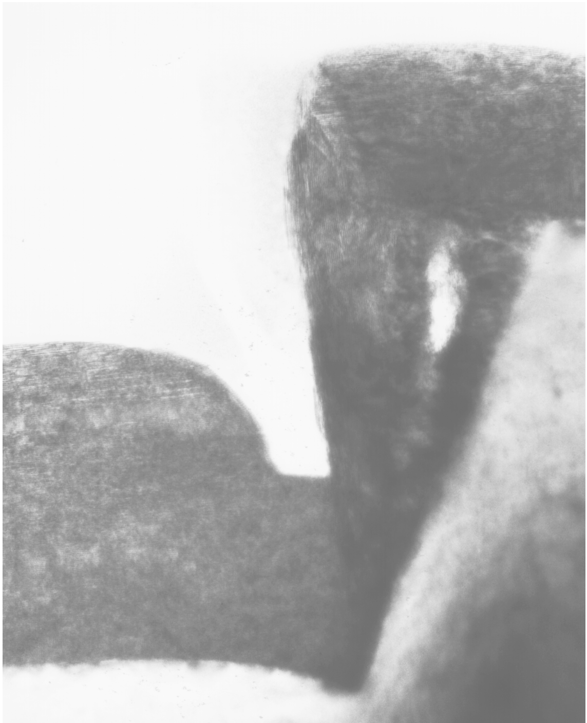
Abb. 3.18: TEM-Aufnahme eines 200 nm dicken hochdruckgesputterten Films ( T_{sub} = 740^{\circ}C ) auf einer 250 nm hohen Substratstufe. (Die Aufnahme wurde von Dr. C.L. Jia vom Forschungszentrum Jülich angefertigt.)
