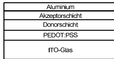
Abbildung 5: Schematischer Aufbau einer Doppelschichtsolarzelle
