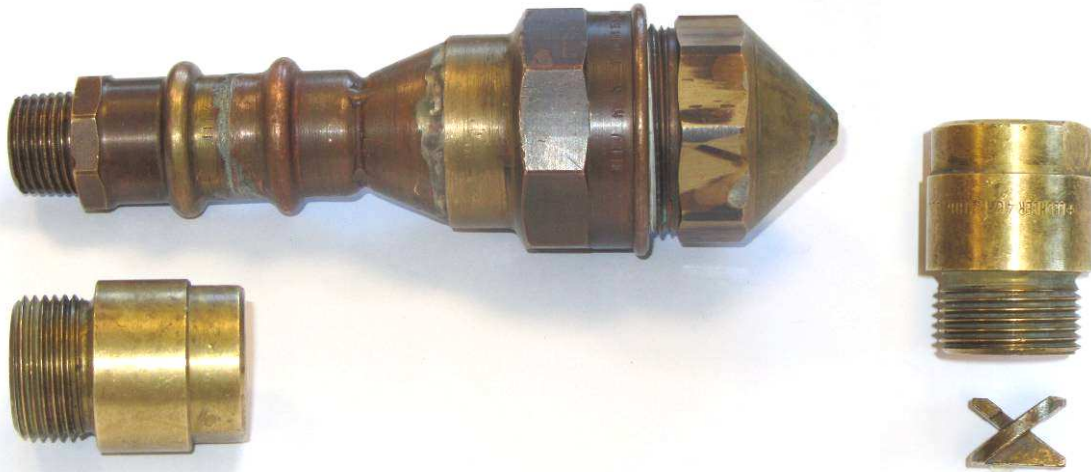
Abbildung 5-28 Gegenüberstellung der beiden Dralldüsen (Eigenbau und Fa. Lechler)
