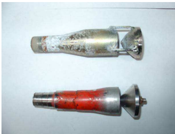
Abbildung 5-14 Oben: feste und unten: verstellbare Kegeldüse aus einem BG50
