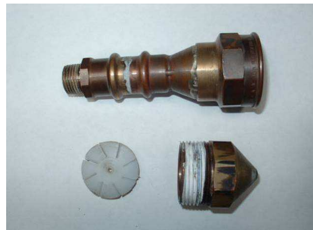
Abbildung 5-15 Einzelteile der selbstentwickelten Dralldüse mit einsetzbarem Drallkörper
