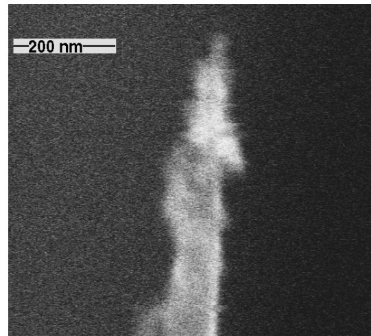
Abb. 5.1 Hochauflösendes SEM-Aufnahme eines Ausschnitts des mit nanokristallinem Diamant beschichteten Si-Spitzen-Arrays (Probe S1, links) bzw. einer beschichteten Si-Spitze (rechts).
