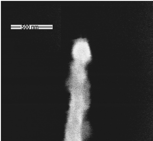
Abb. 5.7 Hochauflösende SEM-Aufnahme einer aufgrund einer Hochstrombelastung abgestumpften ND-beschichteten Si-Spitze.
