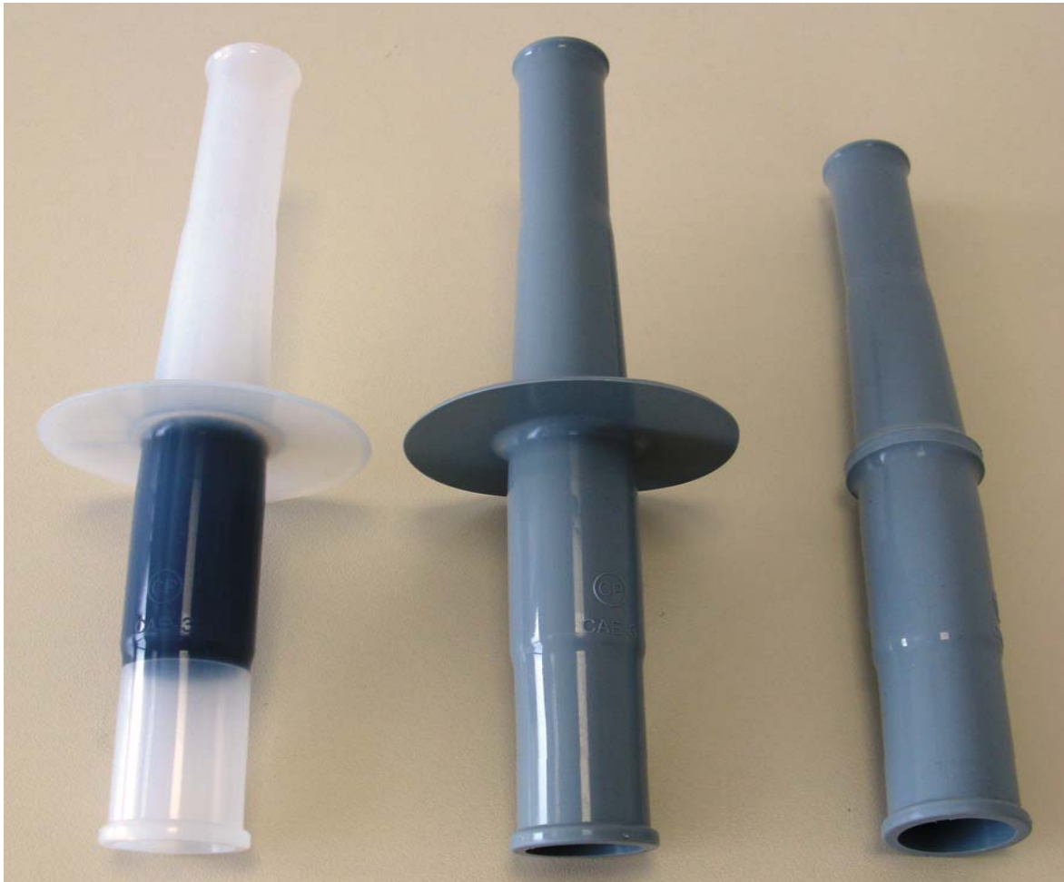
Abbildung 4.33.: Auf der linken Seite eine Testkabelgarnitur ohne Farbpatch, in der Mitte die Standardkabelgarnitur und auf der rechten Seite die untersuchte Kabelgarnitur ohne Schirm. [B7]
