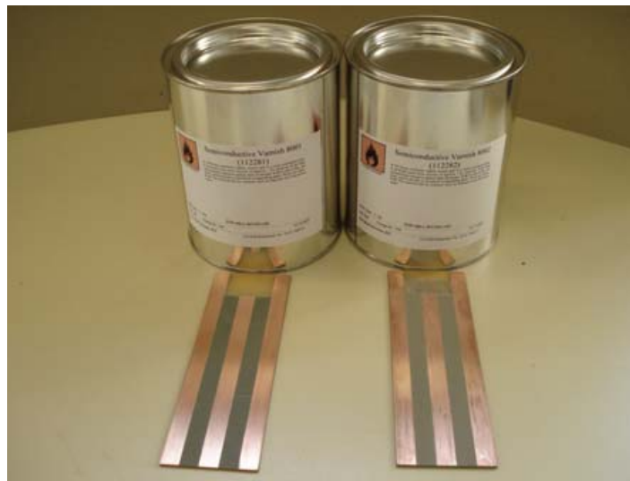
Abbildung 2.5.: Auf Epoxidplatten mit Kupferbahnen wird Lack mit Mikrovaristormaterial aufgetragen [mit freundlicher Genehmigung von VonRoll Schweiz AG].
