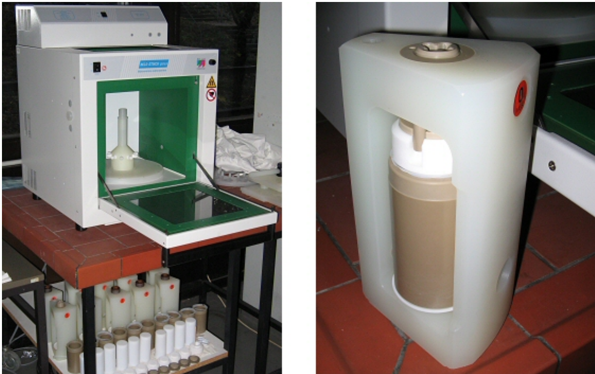
Abbildung 11: Labormikrowellensystem ETHOSplus der Firma MLS GmbH und PTFE Druckgefäß
