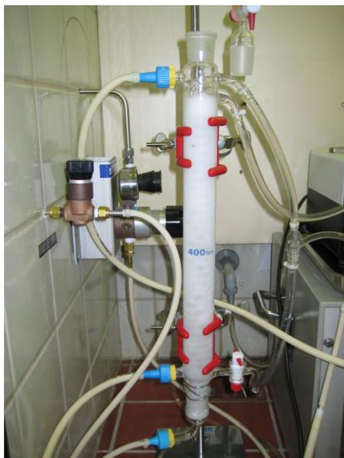
**Abbildung 19: Blasensäulenreaktor mit Reaktionslösung**
