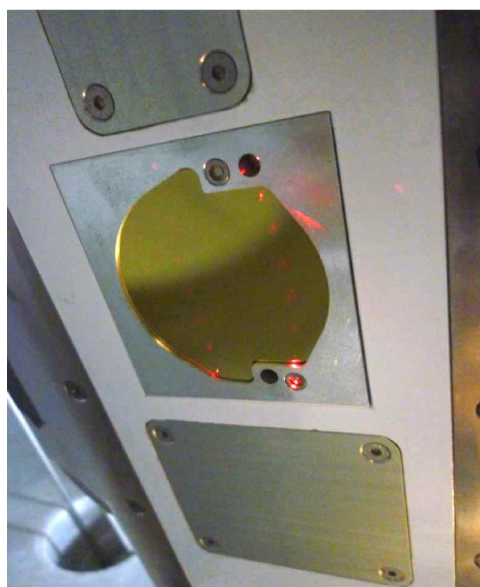
(b) Spiegelhalter mit Detektoren und Faserauskopplungen
