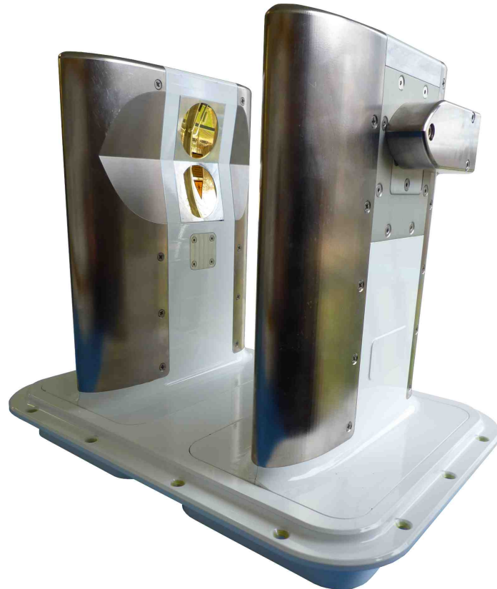
Abbildung 7.1: Frontansicht der offenen Messzelle des HAI
