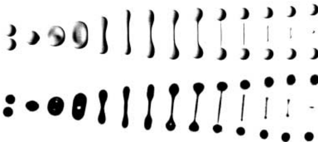
Abbildung 6.1: Tropfenkollision: unten Experiment, oben Simulation
