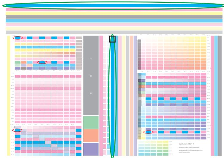
**Abbildung 8.16:** Positionierung von Referenzstreifen (grün markiert) zur Berücksichtigung der Farbschichtdickenvariation der jeweiligen Bezugsfelder (rot markiert) und das Referenzfeld (schwarz markiert) für die relative Schichtdickenbetrachtung.
