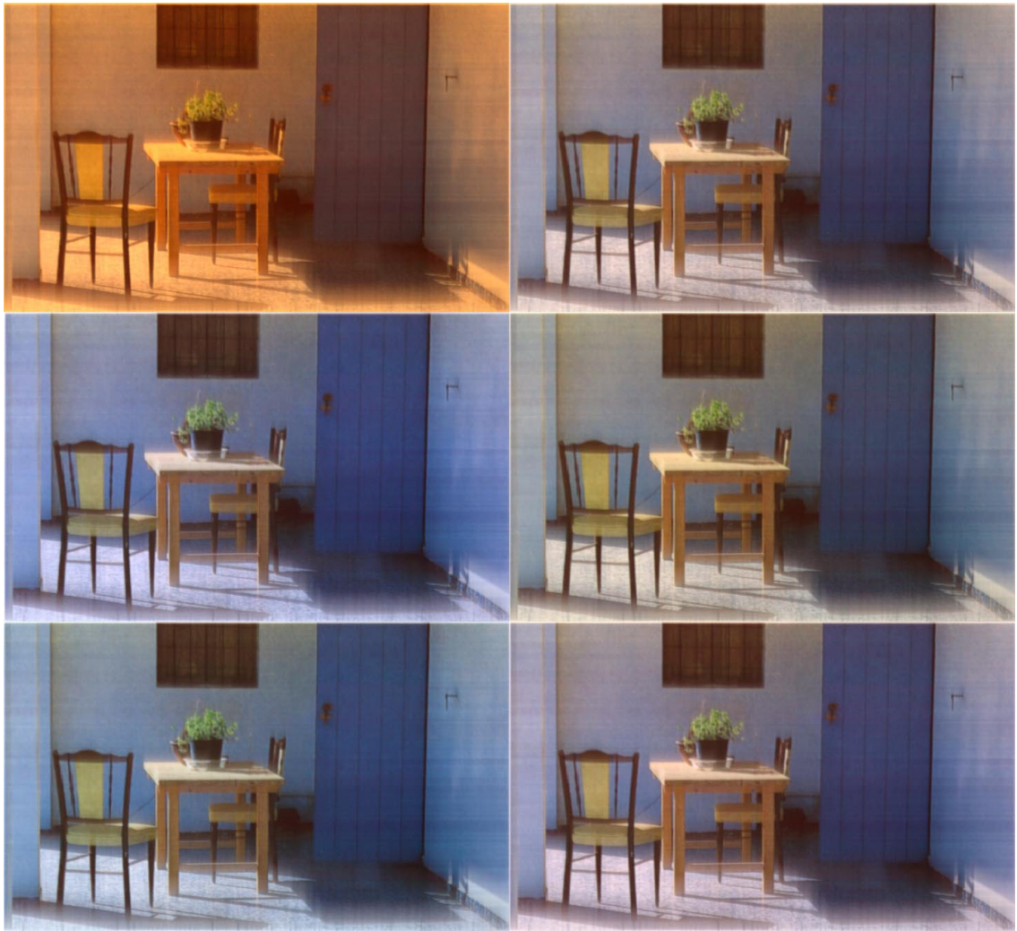
Abb. 7.15: Bildmotiv mit hohem Blauanteil ausgewertet nach den Lichtarten A, B (obere Reihe), C, D50 (mittlere Reihe), D65 und E (untere Reihe) jeweils von links nach rechts
