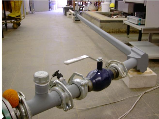
**Abbildung 5.37:** Versuchsaufbau zur Bestimmung des Lisenen-Restdrucks
