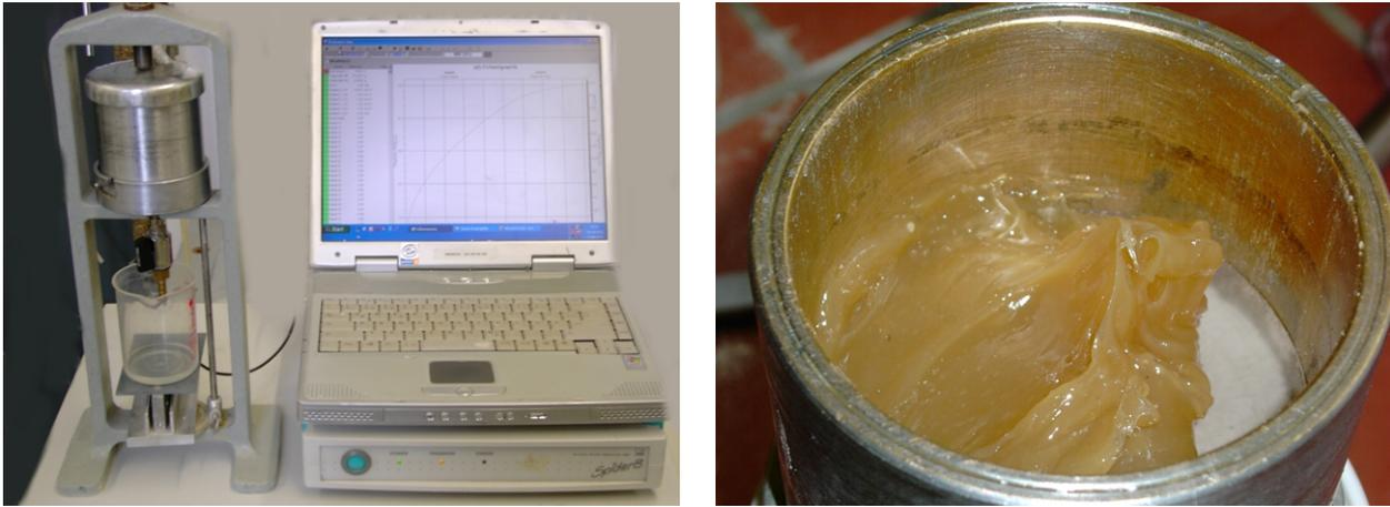
**Abbildung 6.6:** Modifizierter Filterpressenversuch
