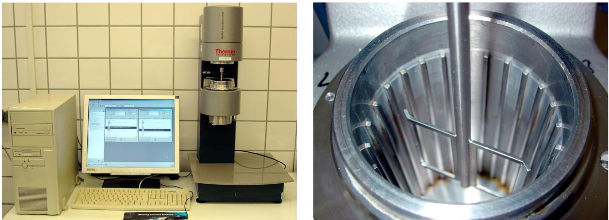
**Abbildung 5.22:** Rheometriesystem HAAKE Rheostress 600 mit Baustoffmesszelle
