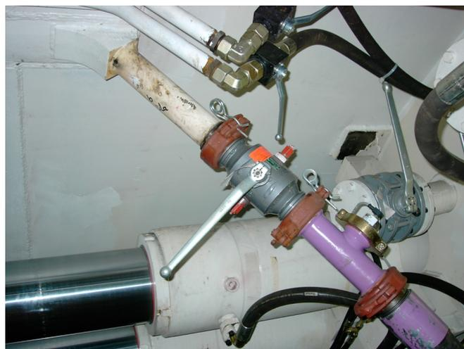
**Abbildung 1.8:** Lisenenanschluss mit Kugelhahn und Druckgeber auf einer TVM
