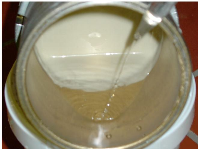
**Abbildung 4.5:** Einfüllen von Wasser für den Durchlässigkeitsversuch in der Filterpresse
