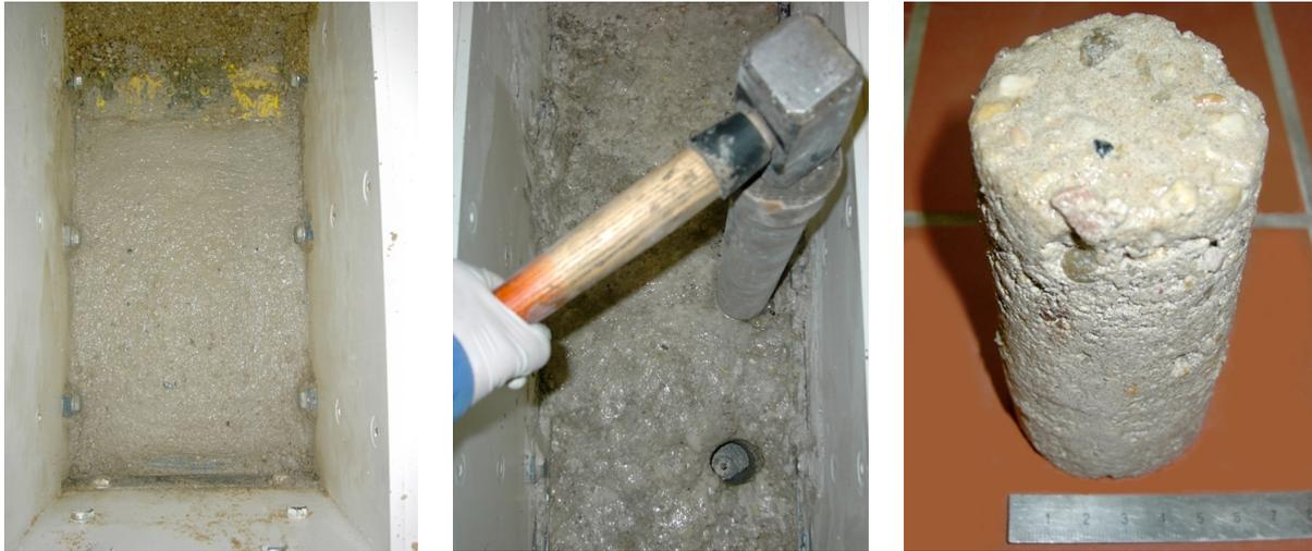
**Abbildung 6.27:** Verpresstes Mörtelmaterial (Versuch gegen Kiessand)
