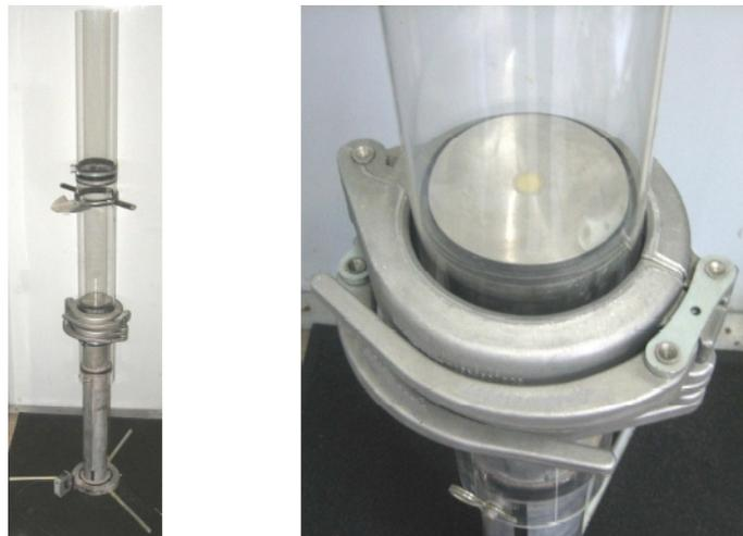
**Abbildung 5.5:** Gleitrohr-Rheometer von Putzmeister, Quelle: [124]
