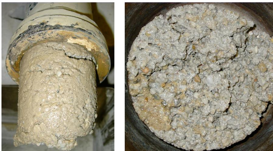
**Abbildung 5.15:** Verfestigtes Mörtelmaterial nach Stopferbildung
