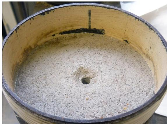
rechts: Durchflusskanal vor Versuchsbeginn
