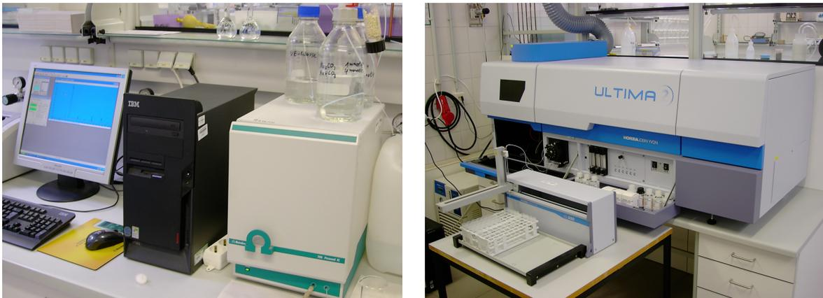
**Abbildung 6.29:** Analyse-Geräte zur Bestimmung der Ionen- und Elementkonzentrationen
