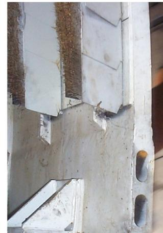
**Abbildung 1.4:** Ringspaltverpressung durch den Schildmantel, Quelle: Herrenknecht AG
