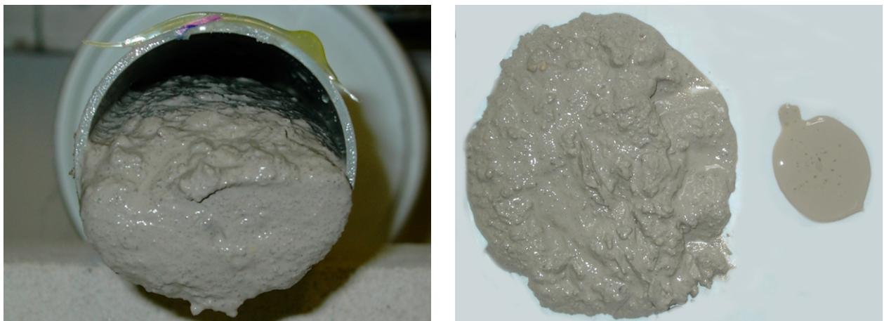
**Abbildung 5.32:** Beobachtung des Blutungsverhaltens in Abhängigkeit der Rohrgeometrie links: Abgesetzter Mörtel in einem Rohr DN 40 mm nach 24 Stunden, rechts: Mörtel und Blutwasser
