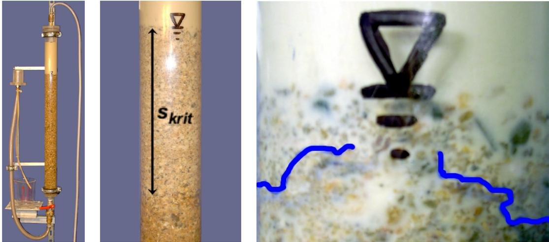
**Abbildung 4.13:** Suspensions-Eindringversuch
