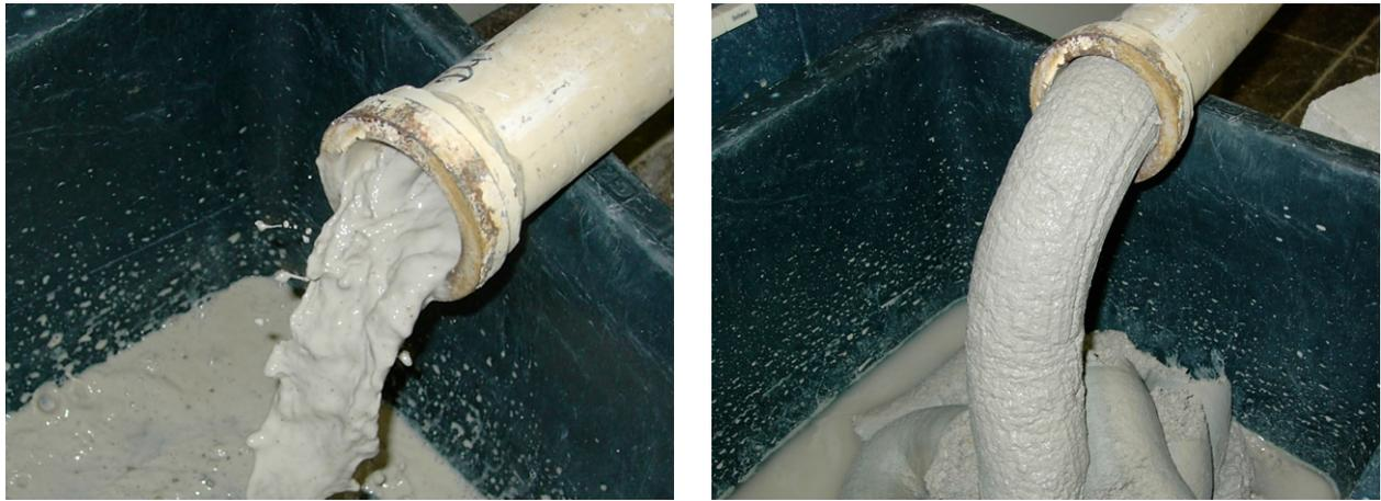
**Abbildung 5.36:** Mörtelförderung beim Wiederanlauf des Pumpensystems nach 4 Tagen
