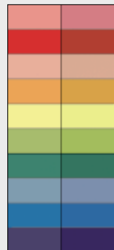
Abb. 138 Farbverschiebungen bei Glühlampenlicht
