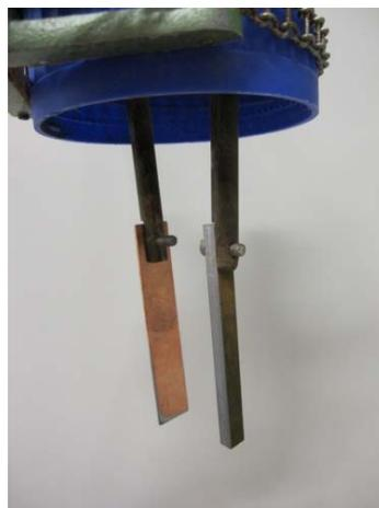
**Abbildung 64: Anordnung der Elektroden zur Elektrolyse von 6:2 FTS.**
