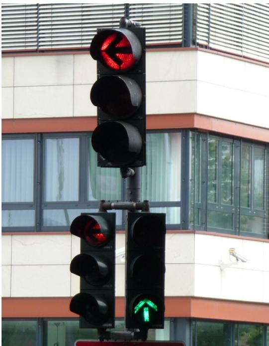
Abbildung 68: Sichere Signalisierung des linksabbiegenden Kraftfahrzeugverkehrs durch eigene Signalphase [Foto: Boenke]
