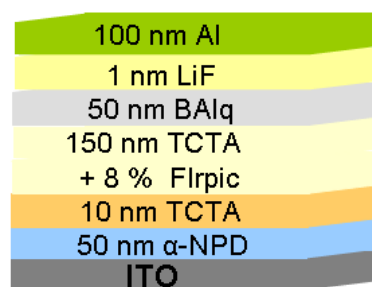
Abbildung 28 Modelldevice für die Aufklärung von Degradationsmechanismen
