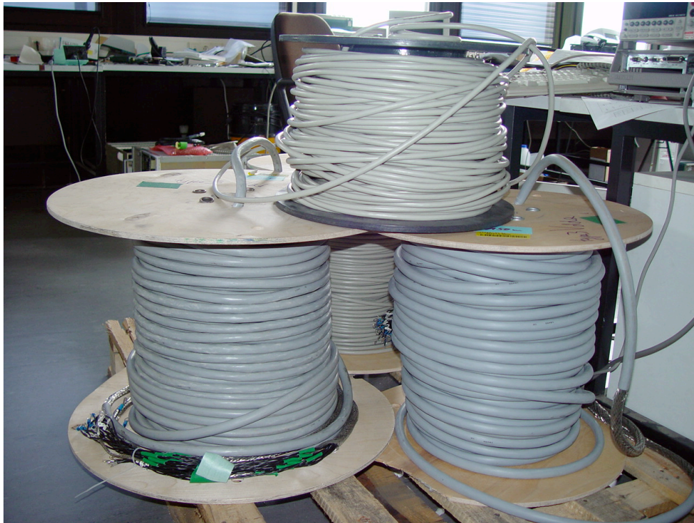
Abbildung 4.3: Kabeltrommeln für die Verkabelung einer Auslesegruppe
