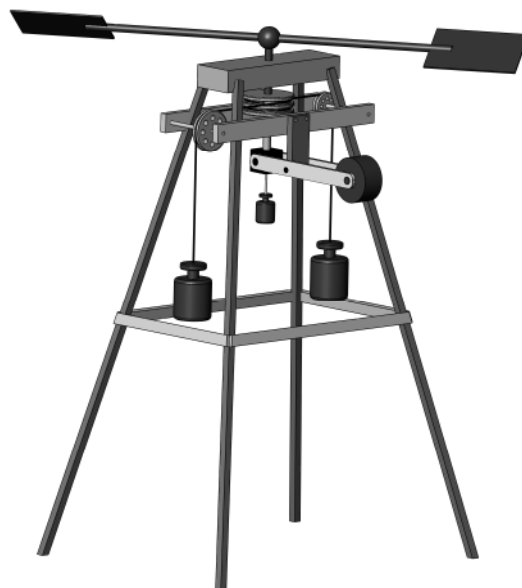
Abb. 1: Prinzipdarstellung des Rundlaufapparates von OTTO LILIENTHAL 1889 [44]
