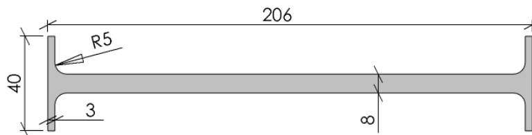
Abb. 70: Modellquerschnitt der TACOMA BRÜCKE nach BERGMANN [1]
