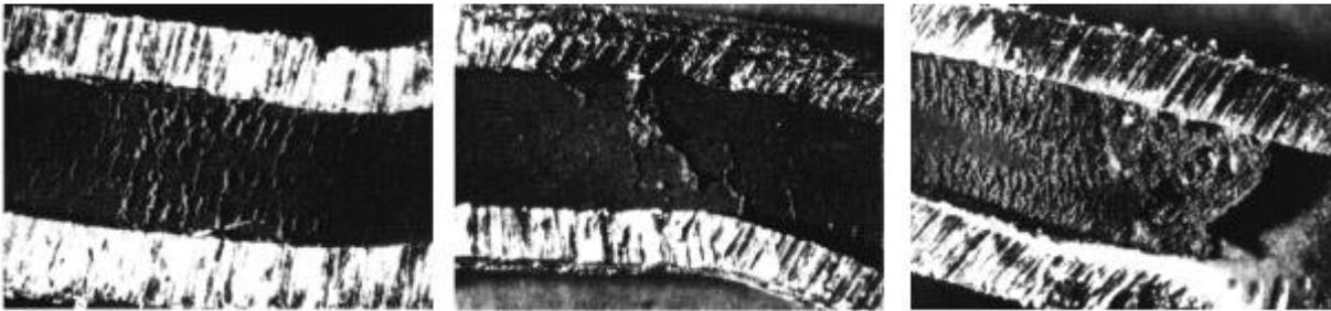
**Bild 1.5:** Ablagerungen in einem Hohlteilleiter (aus /90.Sc-Em/)
