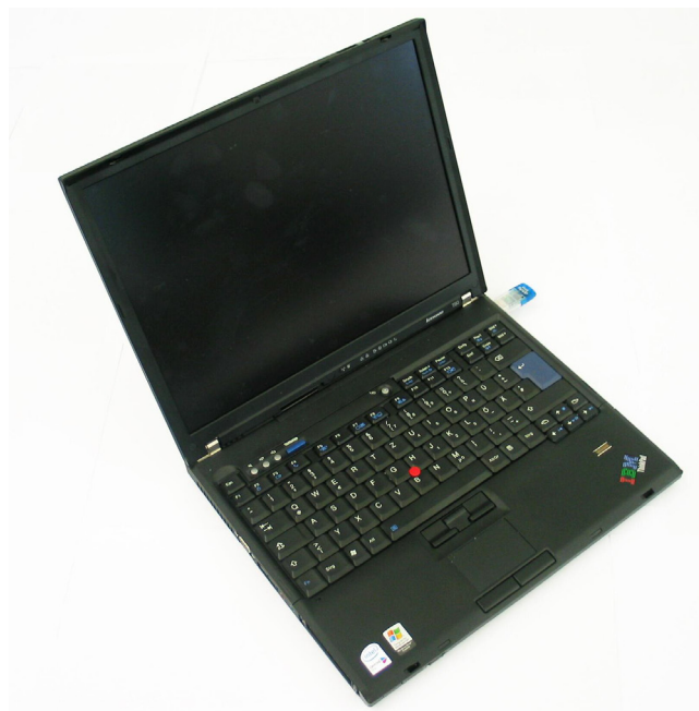
Bild 2.3: Notebook LENOVO Thinkpad T 60 mit eingesetztem Bluetooth-USB-Adapter Typ BlueFritz! USB v2.0 (typ. Nutzerentfernung: 1 – 50 cm)
