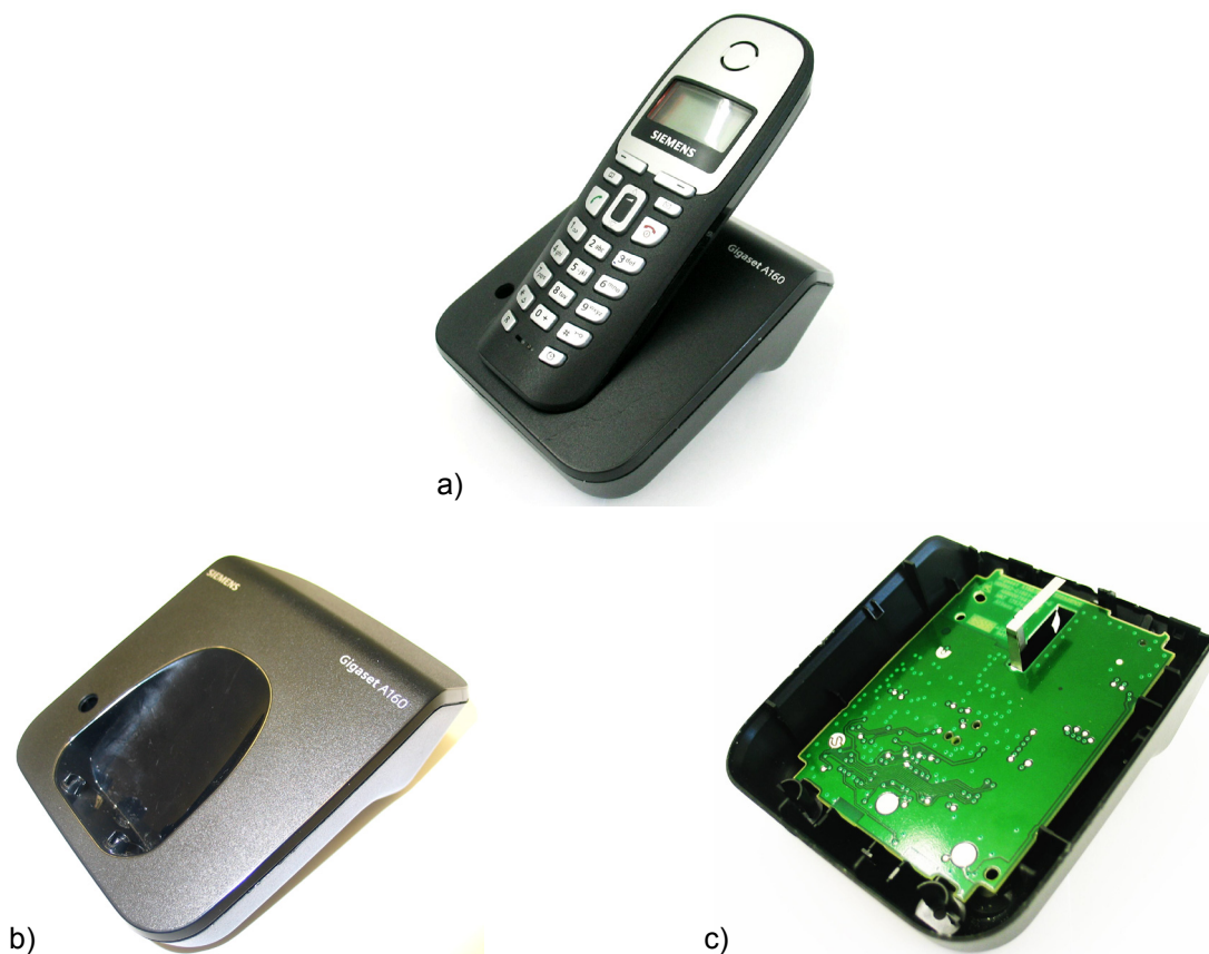
Bild 2.6: DECT-Schnurlostelefon Typ Siemens Gigaset A160 (typ. Nutzerentfernung: 40 cm) a) Gesamtansicht b) Außenansicht der Basisstation c) Oberseite der Basisstations-Platine mit 'inverted-F'-Antenne
