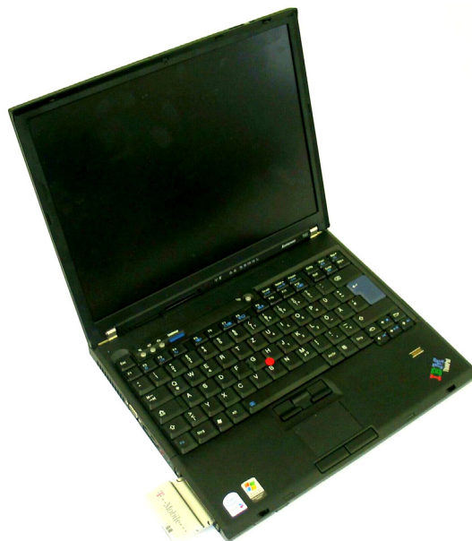
Bild 2.1: Notebook LENOVO Thinkpad T 60 mit eingesetzter PCMCIA-Karte Typ T-Mobile wnw Card W-LAN (typ. Nutzerentfernung: 1 – 50 cm)
