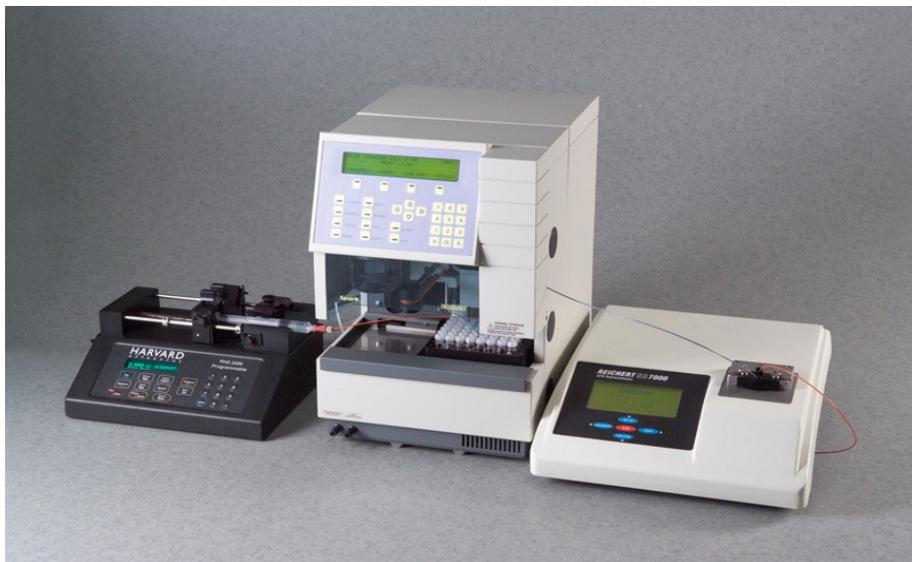
Abbildung 1: SPR-Gerät SR7000 Firma Reichert (Depew, NY USA), mit Autosamplern und Pumpe [2]
