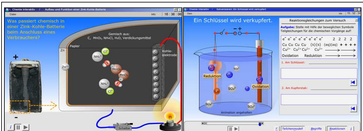
Abb. 23: Abläufe in einer Zink-Kohle-Batterie. Funktionsmodell zu den elektrochemischen Vorgängen. [L20]
