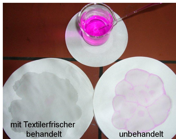
Abb. D.6: Nachweis von Cyclodextrinen in Textilerfrischern mit Phenolphthalein
