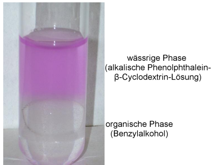
Abb. 3.12: Versuchsergebnis beim Gastaustausch im Phenolphthalein- \beta -Cyclodextrin-Komplex durch Benzylalkohol
