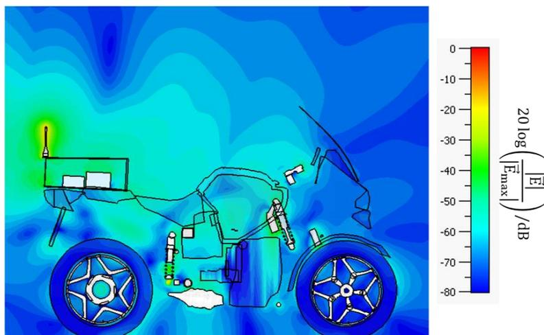
Abbildung 4.8: Verteilung der normierten elektrischen Feldstärke in einer vertikalen Ebene mittig durch die Monopolantenne und das Motorradmodell für  $f = 380$  MHz
