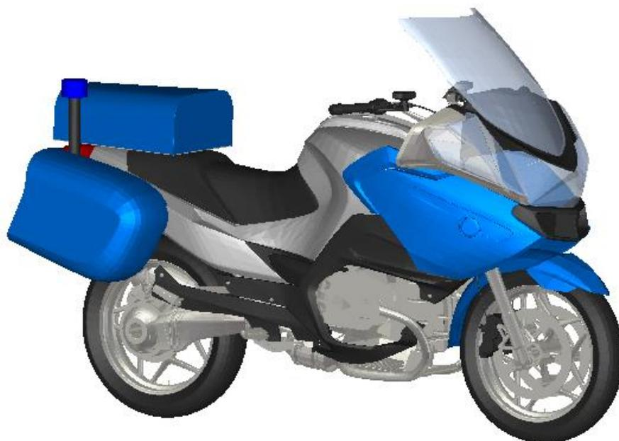
Abbildung 4.3: CAD-Modell des Motorradmodell „R 1200 RT“ des Herstellers BMW für die Verwendung in numerischen Feldsimulationen innerhalb der Software CST Microwave Studio
