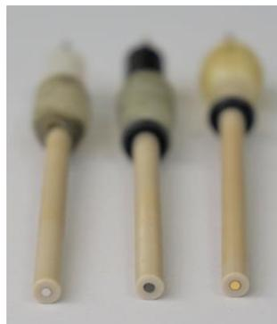
**Abb. 38:** 1mm Platin-, polierte Graphit- und Gold-Elektrode in Scheibenform.
