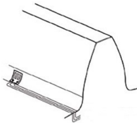
Abb. 6.26: Positionierung der DMS am Zahnfuß [22]
