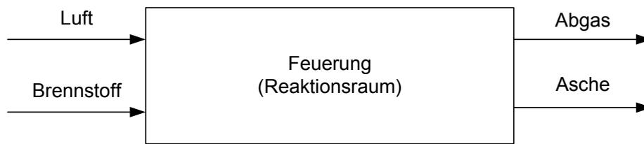
Abbildung 2.1: Schema einer technischen Feuerung (Baehr/Kabelac (2012)).
