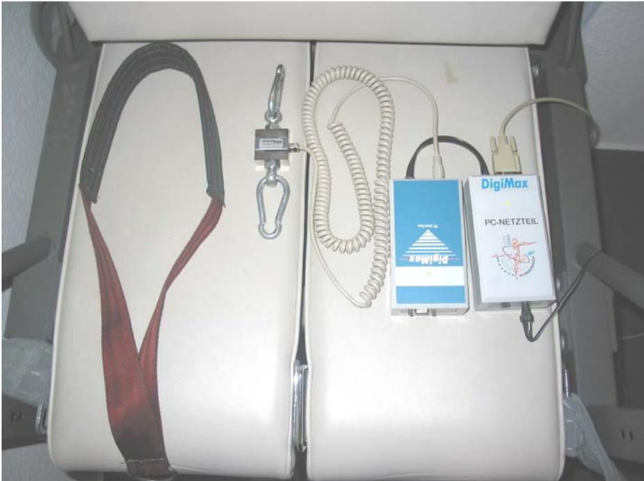
Abbildung 25: Messsystem zur Bestimmung der isometrischen Maximalkraft
