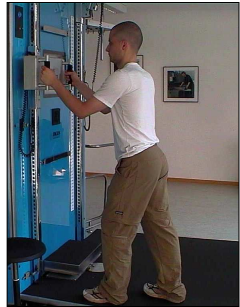
Abb. 22: Unit 1A – Isometrische Maximalkraft, Heben auf Tischhöhe
