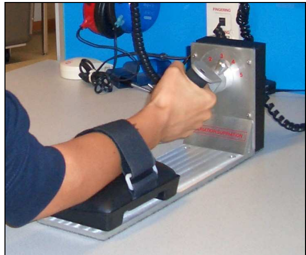
Abb. 38: UNIT 51 – Statische maximale Pronation und Supination im Unterarm
