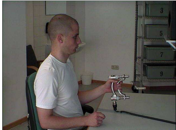
Abb. 34: UNIT 5F – Statische maximale Handgreifkraft der linken Hand
