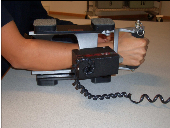
Abb. 37: UNIT 5H – Statische maximale Flexion und Extension im Handgelenk
