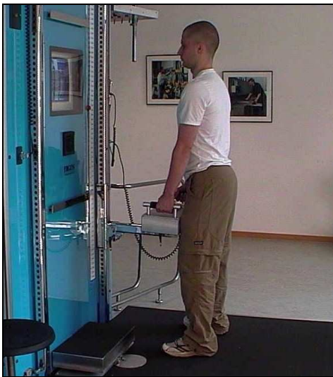
Abb. 23: Unit 1A – Isometrische Maximalkraft, Heben auf Fingerknöchelhöhe
