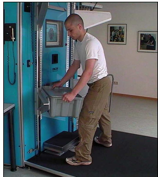
Abb. 24: UNIT 1 – Dynamische Maximalkrafttests, Heben zu linken Seite der Bank
