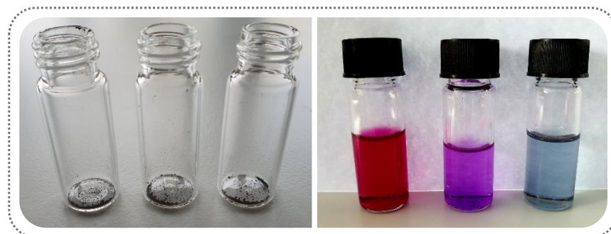
Abb. 111: Partikelrückstände aufgeteilt auf die drei Schraubdeckelgläser. Rechts: Partikelrückstände gelöst in Ethanol, Aceton und Xylol (v.r.n.l.).
