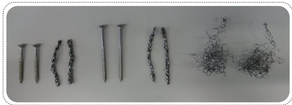
Abb. 116: Getestete Variationen des Elektrodenmaterials.
