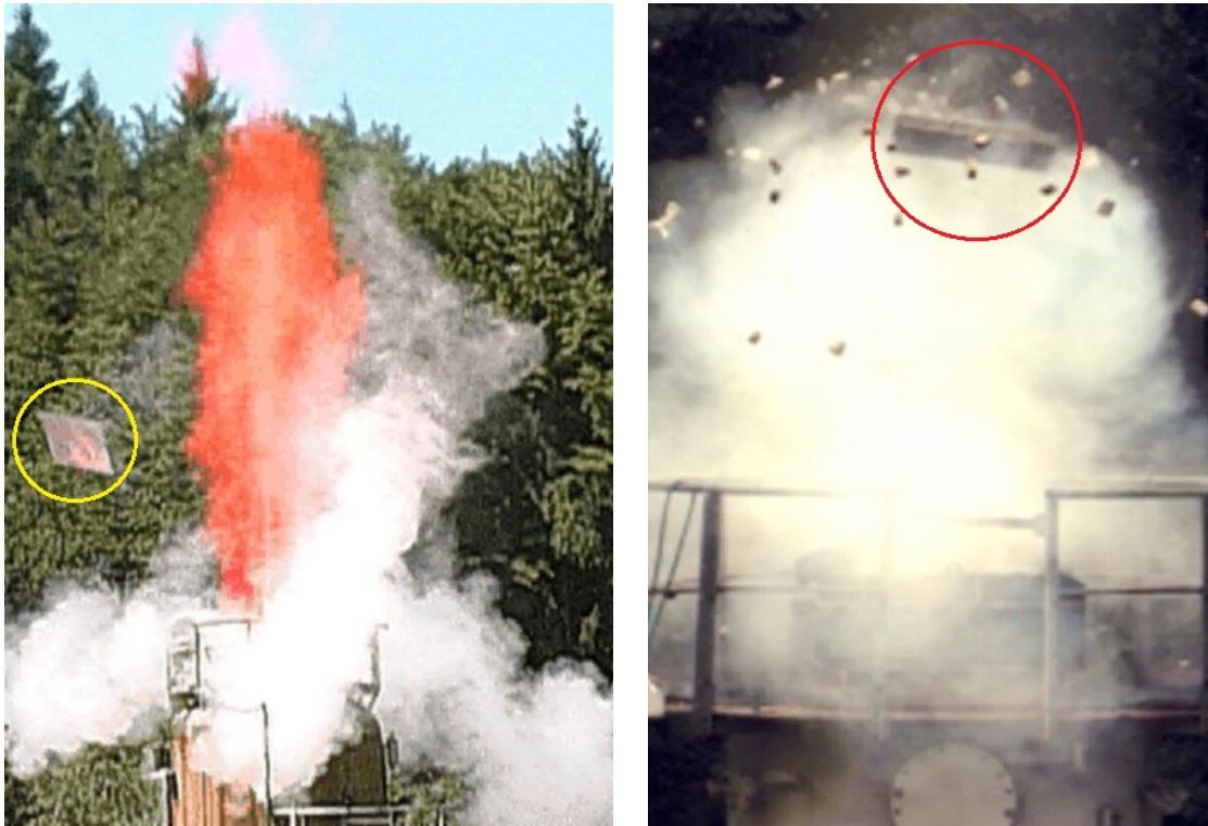
Bild 2.1: Momentaufnahmen aus Videosequenzen von zwei verschiedenen technischen Funktionsprüfungen von Explosionsklappen, die auf dem Versuchsgelände der BGN/FSA durchgeführt wurden [Dirk Lorenz, 2019].
