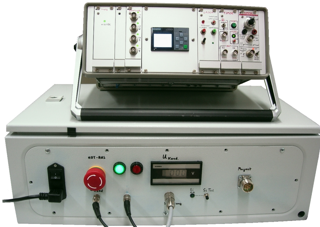
Bild 6.26: Oben: Vereinfachtes Schaltbild der optimierten Elektronik zur Ansteuerung der Magnete. Unten: Foto der überholten Klappensteuerelektronik bestehend aus dem Klappensteuergerät (oben) und dem Leistungsblock (unten) [Dirk Lorenz, 2018].
