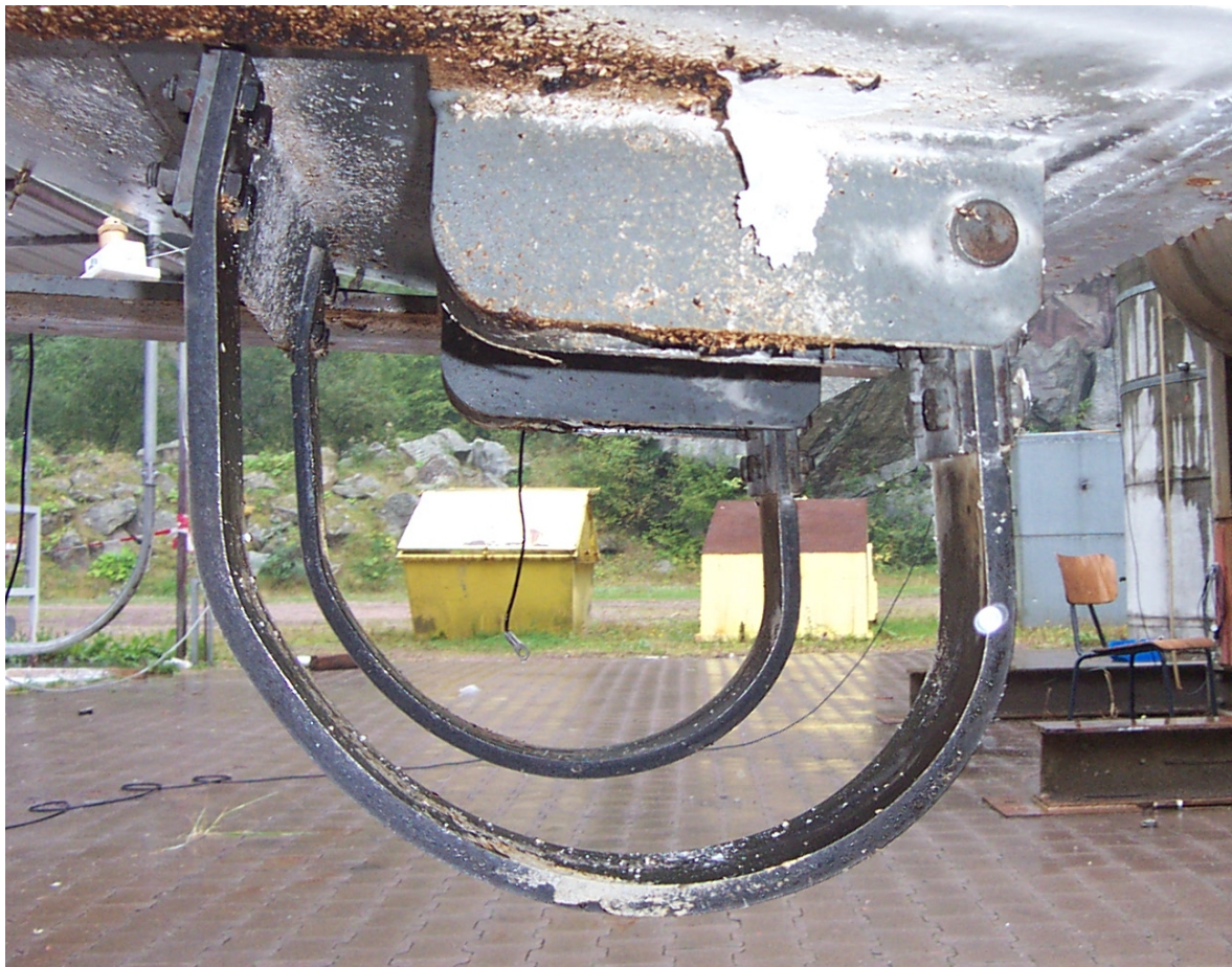
Bild 5.6: Fotografien der 8 mm, 10 mm und 14 mm starken Explosionsklappenbügel nach den Versuchen [Dirk Lorenz, 2002].
