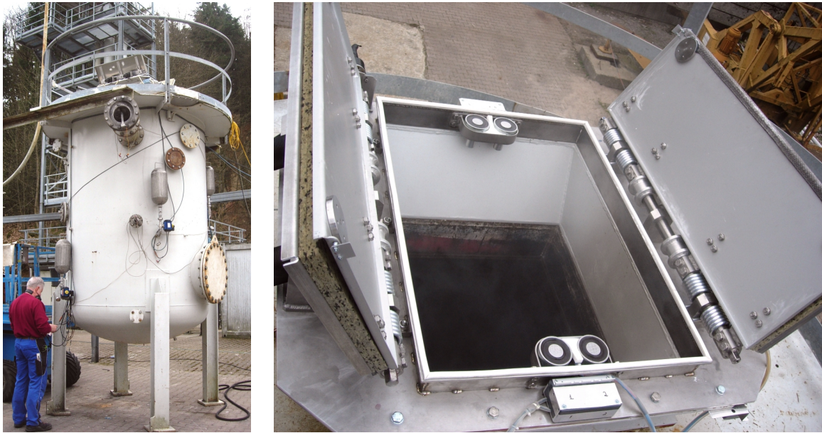
Bild 6.21: Links: Vorbereitung eines Explosionsversuches am 9,4 m 3 -Behälter zur Klappenfunktionsprüfung. Rechts: Die neu entwickelte Explosionsklappe nach dem ersten Explosionsversuch (Nr. 14) [Dirk Lorenz, 2018].
