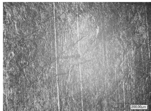
**Abbildung 84:** Aufnahmen der Graphitfolie mit dem Lichtmikroskop bei 100x Vergrößerung (Keyence VHD-1000X), oben: Erstverwendung, unten: angeraut.
