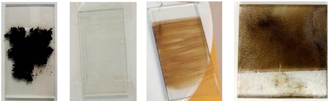
Abbildung 97: Graphen-Gegenelektroden, die mit verschiedenen Herstellungsverfahren angefertigt wurden (von links nach rechts: 1-4) [193]
