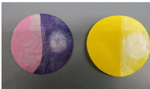
**Abbildung 123:** Filterpapiere (links: Himbeersaft, rechts: Crocin) nach fünfminütiger Bestrahlung mit UV-Licht.
