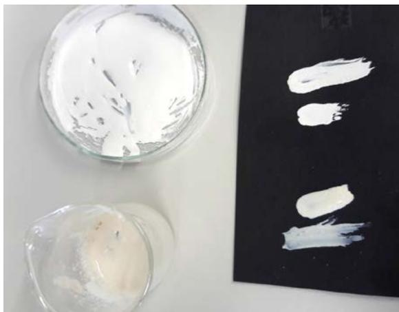
**Abbildung 134:** Herstellung von Deckweißfarben (oben: Titandioxid-Weißpigment, unten: Titandioxid-Nanopartikel).
