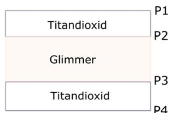
Abbildung 31: Aufbau eines Metalloxid-Substratpigments (adaptiert nach [93], S. 45).
