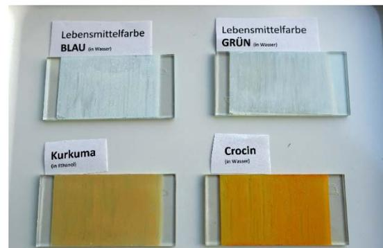
**Abbildung 150: Die eingefärbten Photoelektroden nach der Photosensibilisierung.**
