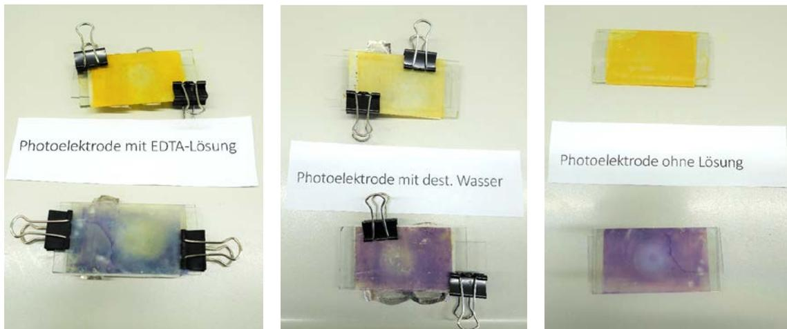
**Abbildung 120: Bestrahlung von photosensibilisierten Photoelektroden mit UV-Licht nach 5 Minuten.**
