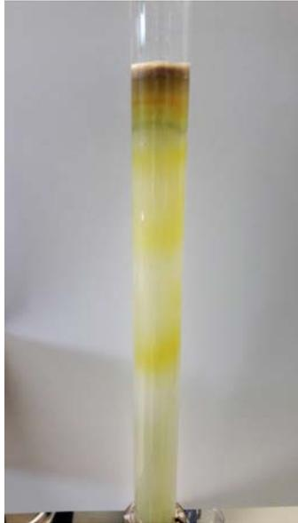
Abbildung 75: Säulenchromatographie des Spinat-Extrakts.
