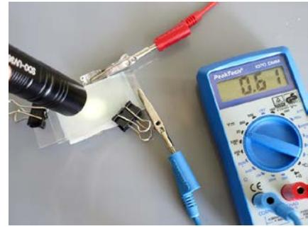
Abbildung 81: Die photogalvanische Kompaktzelle mit Rasierscherfolien als Gegenelektrode.
