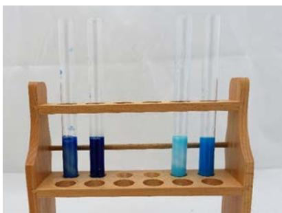
**Abbildung 42: Versuch 2 nach Belichtung, von links nach rechts: 1) DCIP mit Titandioxid, 2) DCIP ohne Titandioxid, 3) MB mit Titandioxid, 4) MB ohne Titandioxid.**
