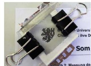
**Abbildung 107: Modifizierter Aufbau der transparenten Solarzelle.**
