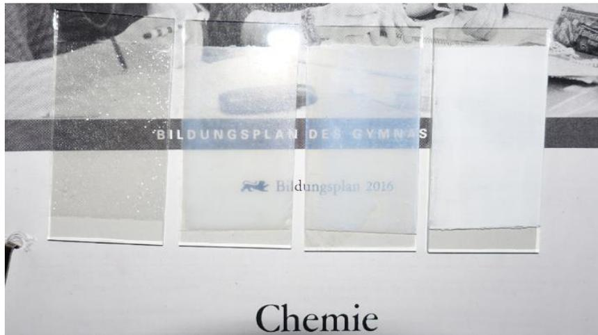
**Abbildung 46: Photoelektroden verschiedener Titandioxid-Sorten und ihre Transparenz. Von links nach rechts: Venator Hombikat XXS 100 = <7 nm, Evonik P90 = 14 nm, Evonik P25 = 21 nm, Venator Hombikat UV 100 = <10 nm.**
