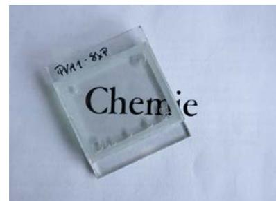
Abbildung 99: Transparente Solarzelle nach dem Zusammenbau.
