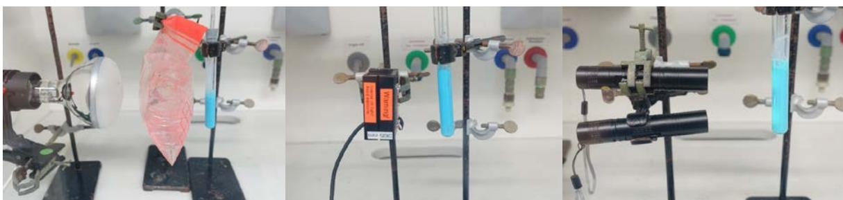
Tabelle 52: Aufbauten zur photokatalytischen Zersetzung einer Methylenblau-Lösung mit verschiedenen UV-Lichtquellen.
