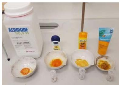
**Abbildung 44: Versuch 2, der Nachweis der Titan-Kationen anhand des nanoskaligen P25 und einer Auswahl an Titandioxid enthaltenen Sonnenschutz-Produkten.**
