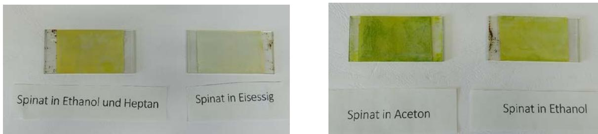
**Abbildung 73: Die Photoelektroden nach der Sensibilisierung und Abwaschen der Zellreste mit destilliertem Wasser.**
