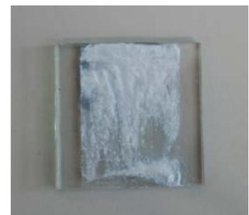
**Abbildung 88:** FTO-Glas mit PEDOT und Titandioxid gerakelt.
