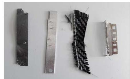
Abbildung 83: Von links nach rechts: Graphitfolie, Platinblech, Carbonegewebe, Rasierscherfolie.
