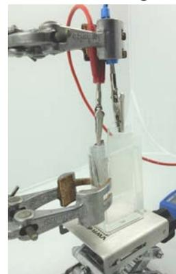
**Abbildung 78: Aufbau der 1-Topfzelle mit der TicTac®-Dose.**
