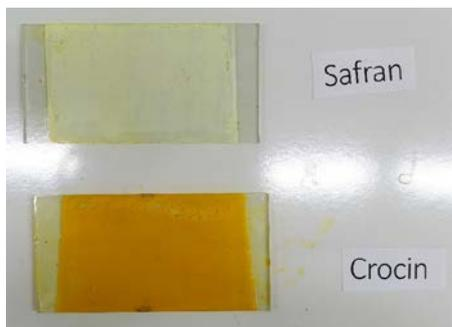
**Abbildung 64: Photoelektroden nach der Sensibilisierung mit Safran-/Crocin-Lösung.**
