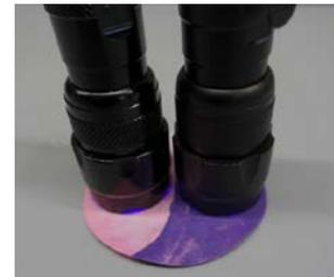
**Abbildung 122:** Belichtung des eingefärbten Filterpapiers, rechts: mit Titandioxid-Schicht.
