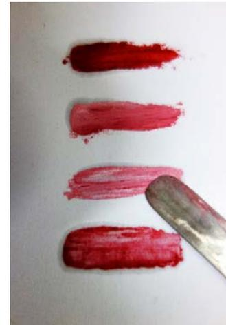
**Abbildung 133:** Aufhellvermögen von verschiedenen Weiß-pigmenten (von oben nach unten: mit Bariumsulfat, Titandioxid, Zinksulfid und Zinkoxid).
