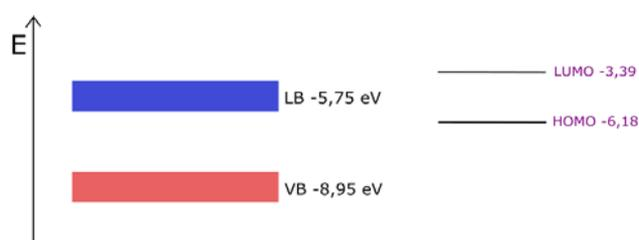
Abbildung 55: Energiediagramm für Titandioxid und Cyanidin.
