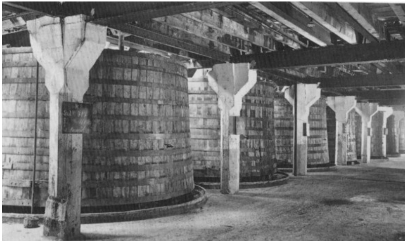
Abb. 168: Twitchell-Spaltanlage (sechs Holz bottiche zu je 30 cbm und zwei zu 20 cbm) in der Glycerinfabrik Geb. E 03
