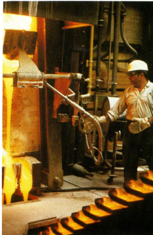
Abb. 211: HENKEL-Wasserglasfabrik um 1985: Ausfluss der Wasserglasschmelze aus dem Schmelzofen.
