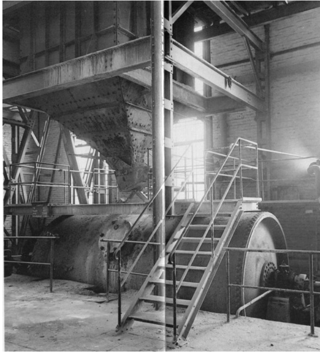
Abb. 205: Wasserglaslöserei: Mittels rotierender Löser und Dampfdruck wurde aus festem Wasserglas flüssiges oder zähflüssiges Wasserglas, je nach gewünschter Konsistenz.
